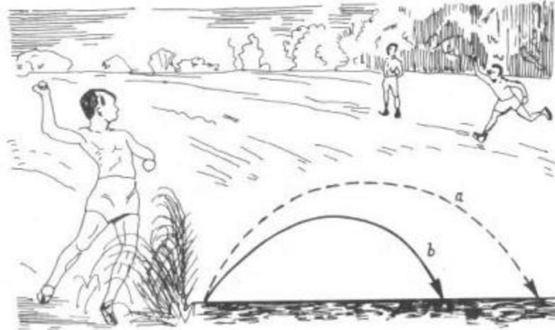
*Debido a la resistencia del aire la pelota sigue una curva balística señalada con línea continua en vez de describir la parábola representada por la línea de trazos*
